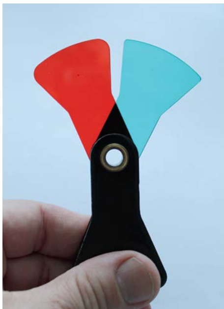
Figur 42. Genom att jämföra hur ljuset från ett föremål filtreras genom ett grönt och ett rött glas kan även en person med nedsatt färgseende bestämma dess färg.
