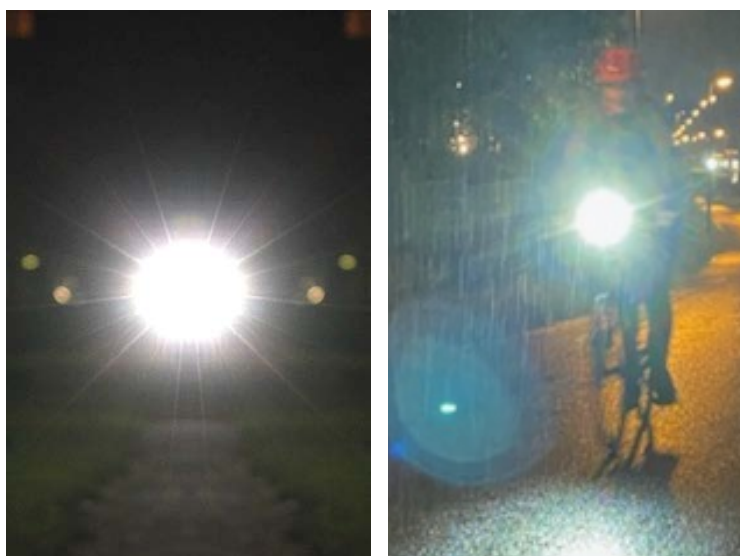
Figur 52. Exempel på bländning orsakad av cykelbelysningar utan vägbelysning (till vänster) och cykelbana med vägbelysning (höger).
