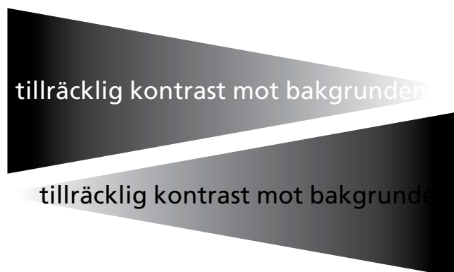
Figur 38. Då kontrasten mellan text och bakgrund minskar till nivåer under en faktor tre blir texten svår att läsa. Detta illustreras i slutet av meningens.
