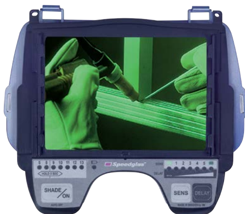
Figur 67. Den bild svetsaren ser genom ett elektrooptiskt visir innan ljusbågen tänds. När svetsningen börjar mörknar glaset omedelbart till en lagom nivå så att svetsaren kan se hur svetsarbetet fortlöper. Då svetsningen upphör blir glaset omedelbart ljust igen.
