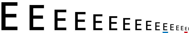
Figur 39. Teckenstorlekar från 60 till 6 pixlar, vilket motsvarar 15 till 1,5 mm. E understruket med röd linje har en höjd på knappt 2 millimeter. Det är ett minimum för läsning på 30 centimeters synavstånd vilket motsvarar läsning av tryckt text i böcker. E understruket med blå linje har en höjd på 4 millimeter vilket är ett minimum för bekväm läsning på 70 centimeters synavstånd till bildskärmen.
