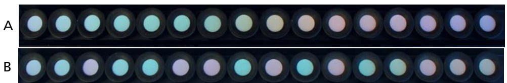
Figur 13. Uppgiften i detta färgsinnestest är att lägga färgkopporna i en jämnt övergående färgskala. Den övre raden (A) har lagts av en person med normalt färgseende, den undre raden (B) av en person med defekt grönseende. (B) uppfattas av personer med defekt grönseende som en jämnt övergående färgskala. Färgernas intensitet har här förstärkts för att skillnaden ska framgå tydligare.
