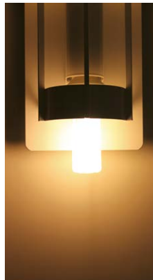
Figur 32. Olika ljuskällor i en och samma armatur avsedd för traditionell glödlampa. Fotona till vänster visar ljuskällans form och hur mycket av dem som täcks av bländskyddet. Fotona till höger visar hur ljuset från lampetten ter sig för betraktaren.
