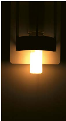
Figur 32. Olika ljuskällor i en och samma armatur avsedd för traditionell glödlampa. Fotona till vänster visar ljuskällans form och hur mycket av dem som täcks av bländskyddet. Fotona till höger visar hur ljuset från lampetten ter sig för betraktaren.
