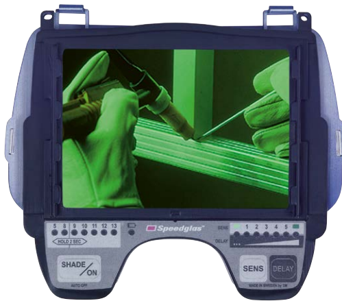
Figur 67. Den bild svetsaren ser genom ett elektrooptiskt visir innan ljusbågen tänds. När svetsningen börjar mörknar glaset omedelbart till en lagom nivå så att svetsaren kan se hur svetsarbetet fortlöper. Då svetsningen upphör blir glaset omedelbart ljus igen.
